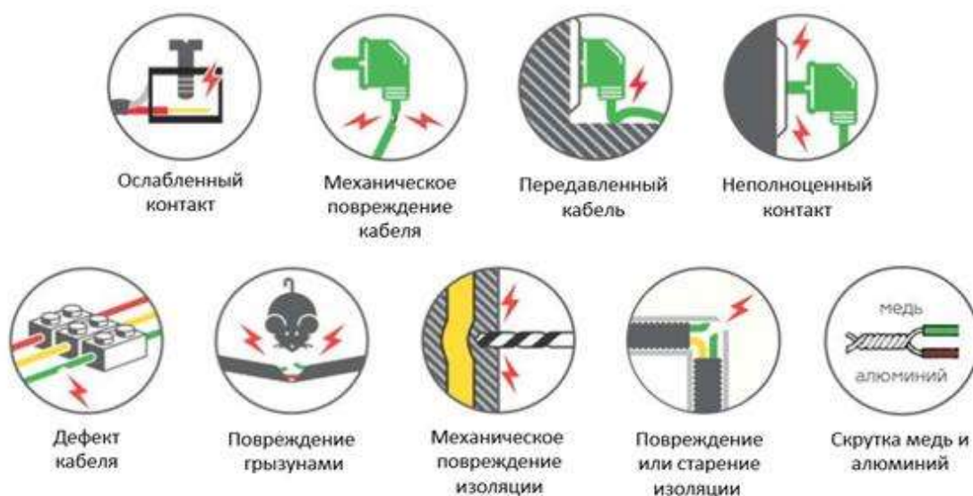
Рисунок 6. Возможные причины искрения в электропроводке
